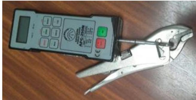
Figura 56: Dinamómetro acoplado al alicate de presión
