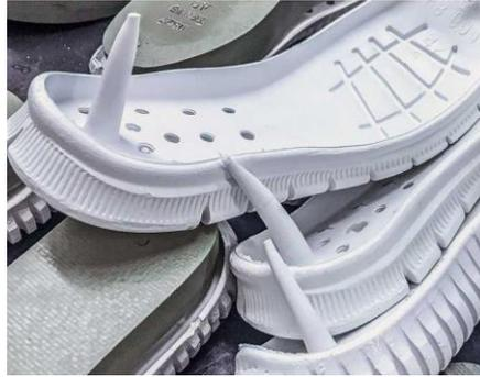
Figura 50: Ejemplo de diseño con elemento para la extracción
