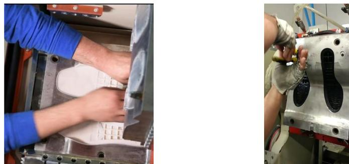
Figura 53: Diferente posición de los pisos a extraer
