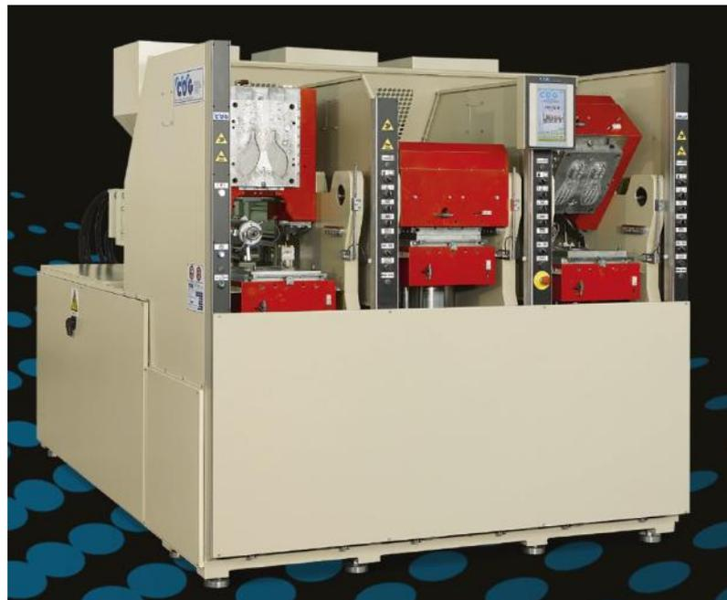
Figura 15: Máquina de inyección (CDG Trading, serie Jolly)
