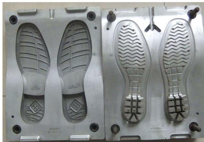
Figura 3: Moldes de inyección para pisos
