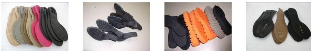
Figura 4: Pisos de diferentes materiales (TPU, TR, EVA, TOFLEX)
